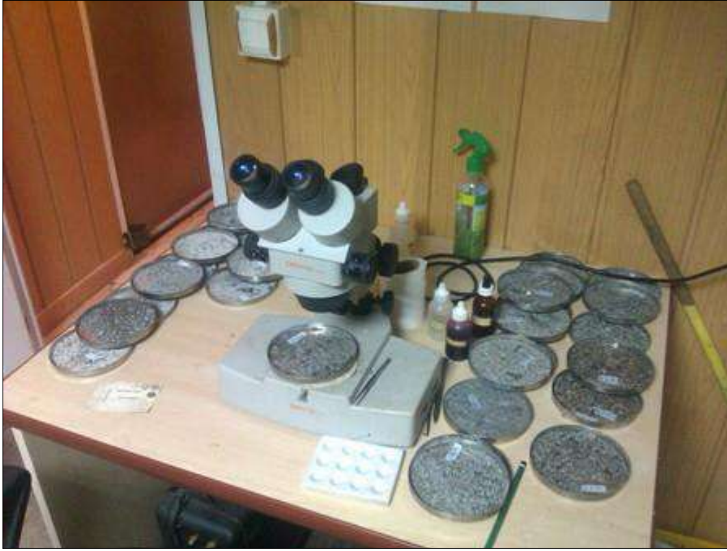
Şekil 5.12. Sondaj ile kesilen kayaç kırıntıları mikroskopta incelenir. Litolojik kuyu loguna işlenir
